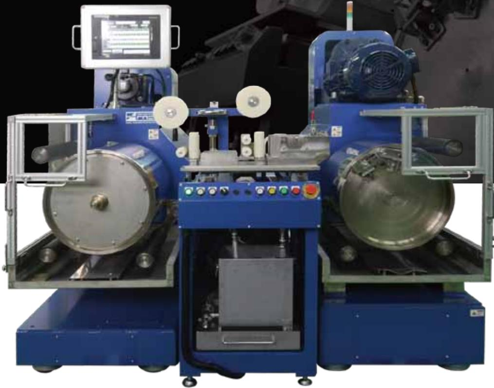
溶融工程で製造された様々な材質の素線を安定した低張力で伸線します。伸線できる素線の線径(細・太)、線種(軟・硬)も幅広く対応。私達の高精度な制御技術で精密な慣性補償を行い、加速時、減速時の張力変動を極限まで減少させることができました。
