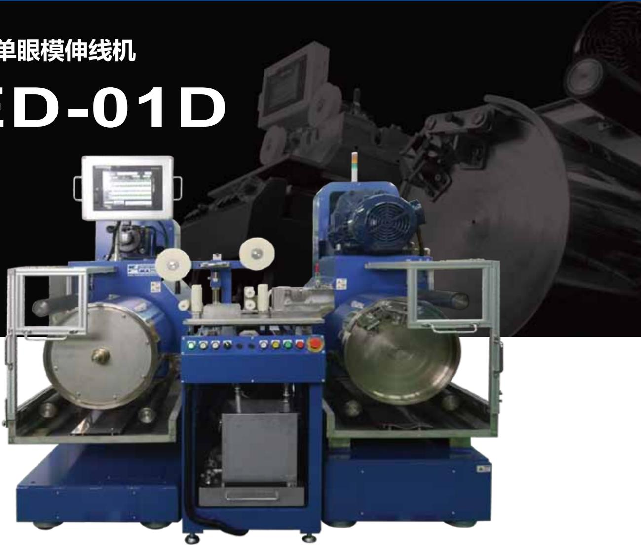
使用安定的低张力可对熔铸工序里制造出来的各种各样的粗线进行伸线。可伸线的粗线范围广，无论线材粗细、还是软硬都可以对应。另外使用本公司高精度的控制技术进行精密的惯性补偿，把加减速时的张力变动降到最低。
