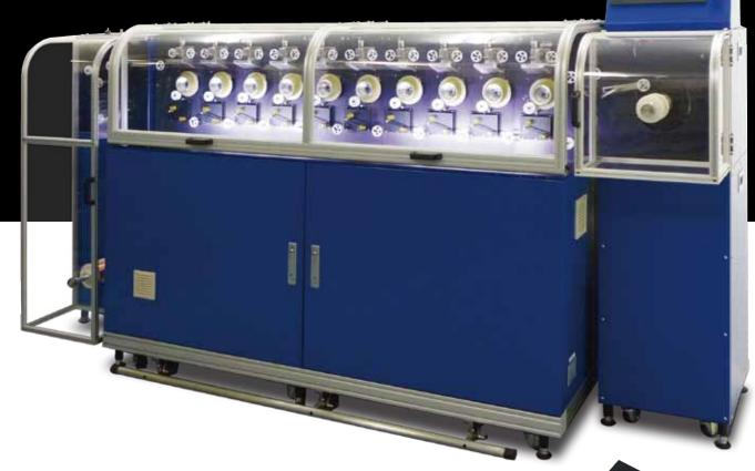
本机器是为了在30µm以下超细金属丝领域开创新的伸线技术而研制开发的。把1个张力浮动杆·1个眼模·1个牵引轮作为一个单元,每台机器由复数个这样的单元构成。同时使用独自开发的控制系统直接控制牵引轮驱动,实现了非滑动伸线。将传统技术(滑动伸线)难以实现的超细金属丝伸线变成现实。
